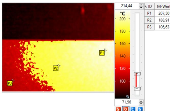
*Ungünstig fusionierte HDR-Aufnahme einer Thermografiekamera. An der Grenze der genutzten Messbereiche entsteht bei einem glatten Temperaturverlauf ein Temperatursprung im Thermografiebild.*
