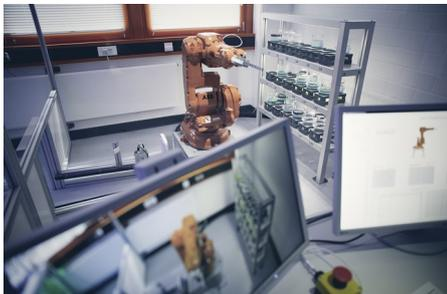
In der Lagerzelle wird ein eigenentwickeltes Programm zur Verwaltung des Hochregallagers und zur Ansteuerung des Knickarmroboters ABB IRB 140 in der Roboterzelle eingesetzt. Dieses Programm wurde unter Windows 7 in C# erstellt.
