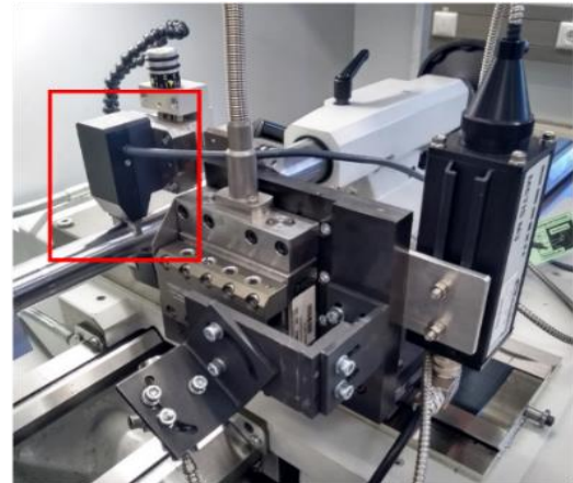
Abbildung 1: Experimenteller Aufbau mit 3MA-Spezialsensorik (markiert in rot)
