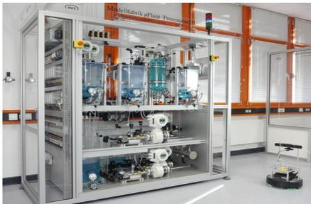
In der Prozessinsel 2 der Modellfabrik soll eine Siemens S7-SPS zur Ermittlung und Aufzeichnung der Raumluft- und Wasserqualität installiert werden, die verschiedene Sensoren (Luftdruck, Luftfeuchte, CO<sub>2</sub>-Gehalt und Temperatur der Luft und Ethanol-Gehalt des Wassers) ausliest und auswertet. Der Zustand der Luft und des Wassers soll mittels einer Ampel (Rot/Gelb/Grün) an der Prozessinsel und auf einem drahtlosen mobilen Endgerät visualisiert werden.
