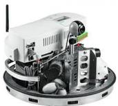
Im Schulungsversuch sollen die Kursteilnehmer innerhalb einer Stunde typische Probleme beim Betrieb von autonomen mobilen Robotern auf der Basis von ROS erfahren und bewerten: Kartenerstellung, Selbstlokalisierung, Odometrie, Wegplanung (vorgegebene Pfade, anzusteuernde Wegpunkte, freie Routenplanung), Kollisionsvermeidung, Hindernisumfahrung, Kooperation, Vergleich Sensoren (Kinect, LIDAR).
