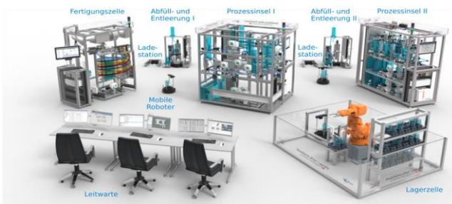
Die Modellfabrik  $\mu$ Plant ist eine vernetzte, größen- und strukturveränderliche Produktionsanlage mit industrieller Instrumentierung und Automatisierung, aber miniaturisierten Einheiten für Fluidprozesse, Stückgutfertigung, Lagerung und Materialtransport mit mobilen Robotern.
