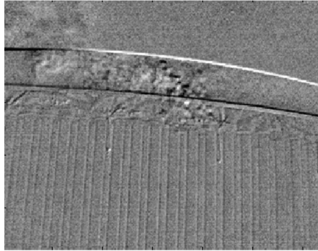
Abbildung 1: Beispiel eines IR-Differenzbildes einer Gasleckage. Die Kanten im Differenzbild werden durch eine Verwackelung der Einzelbilder verursacht.
