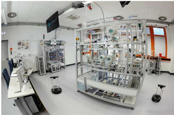
Die Gesamtanlage ist heterogen automatisiert: Die Prozessinsel 1, die Fertigungszelle und die Befüll- und Entleerstationen mit Beckhoff TwinCAT, die mobilen Roboter mit ROS, die Prozessinsel 2 und die Leitwarte mit ABB Freelance/Formulation, der ABB Knickarmroboter mit ABB Rapid, die RFID-Systeme und das Lager mit jeweils eigener Software. Alle Teilsysteme sind informationstechnisch (TCP/IP) integriert.
