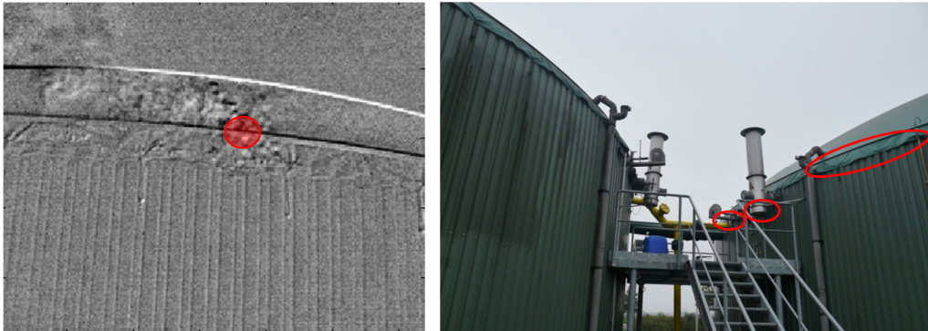
Abbildung 1: Beispiel eines IR-Differenzbildes einer Gasleckage mit schematischer Darstellung des RMLD-Messflecks (links), Teile einer Biogasanlage mit Kennzeichnung möglicher Gasleckagen (rechts)
