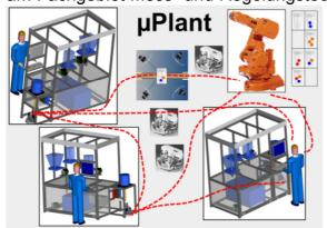
Anlage wird aus mehreren Prozessinseln, einer Roboterzelle und einer optischen Messzelle bestehen, welche mittels mobiler Transportroboter miteinander verbunden sind.
