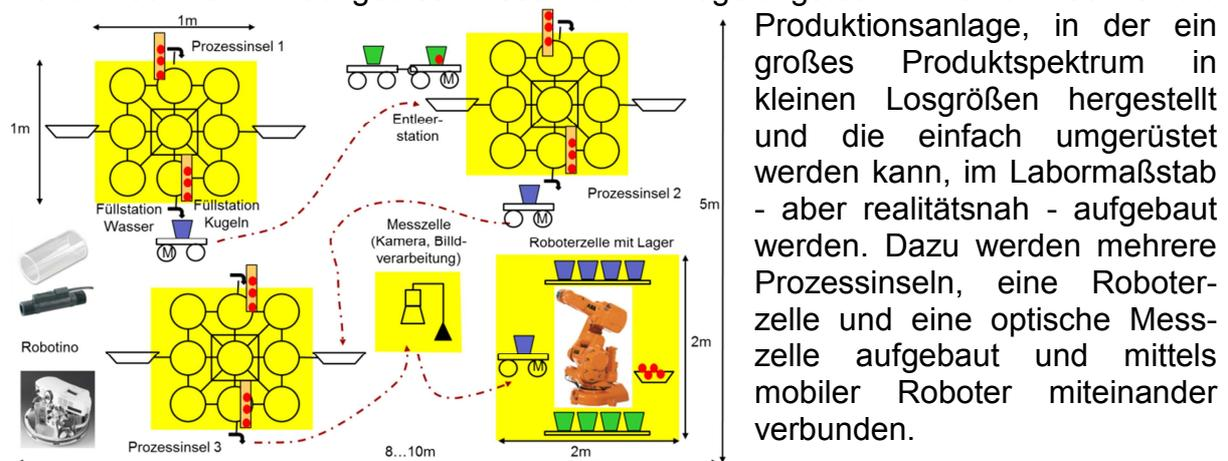
Produktionsanlage, in der ein großes Produktspektrum in kleinen Losgrößen hergestellt und die einfach umgerüstet werden kann, im Labormaßstab - aber realitätsnah - aufgebaut werden. Dazu werden mehrere Prozessinseln, eine Roboterzelle und eine optische Messzelle aufgebaut und mittels mobiler Roboter miteinander verbunden.
